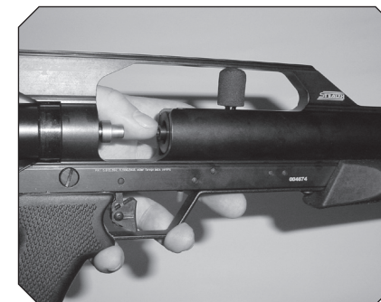
umieszczanie śrutu w komorze załadowniczej
